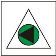
Ref. 2.8 Telemando de las bombas de sentina
