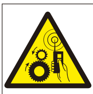
Ref. 308 Peligro maquinaria accionada a distancia
