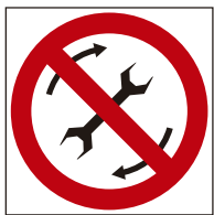
Ref. 482 Prohibido reparar la máquina en funcionamiento
