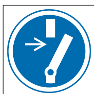
Ref. 259 Desconectar antes de reparación
