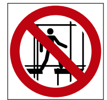
Ref. 462 Prohibido pasar Andamio incompleto
