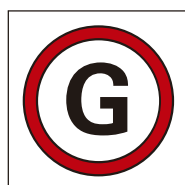
Ref. 2.34 Fuente de energía eléctrica de emergencia (generador)
